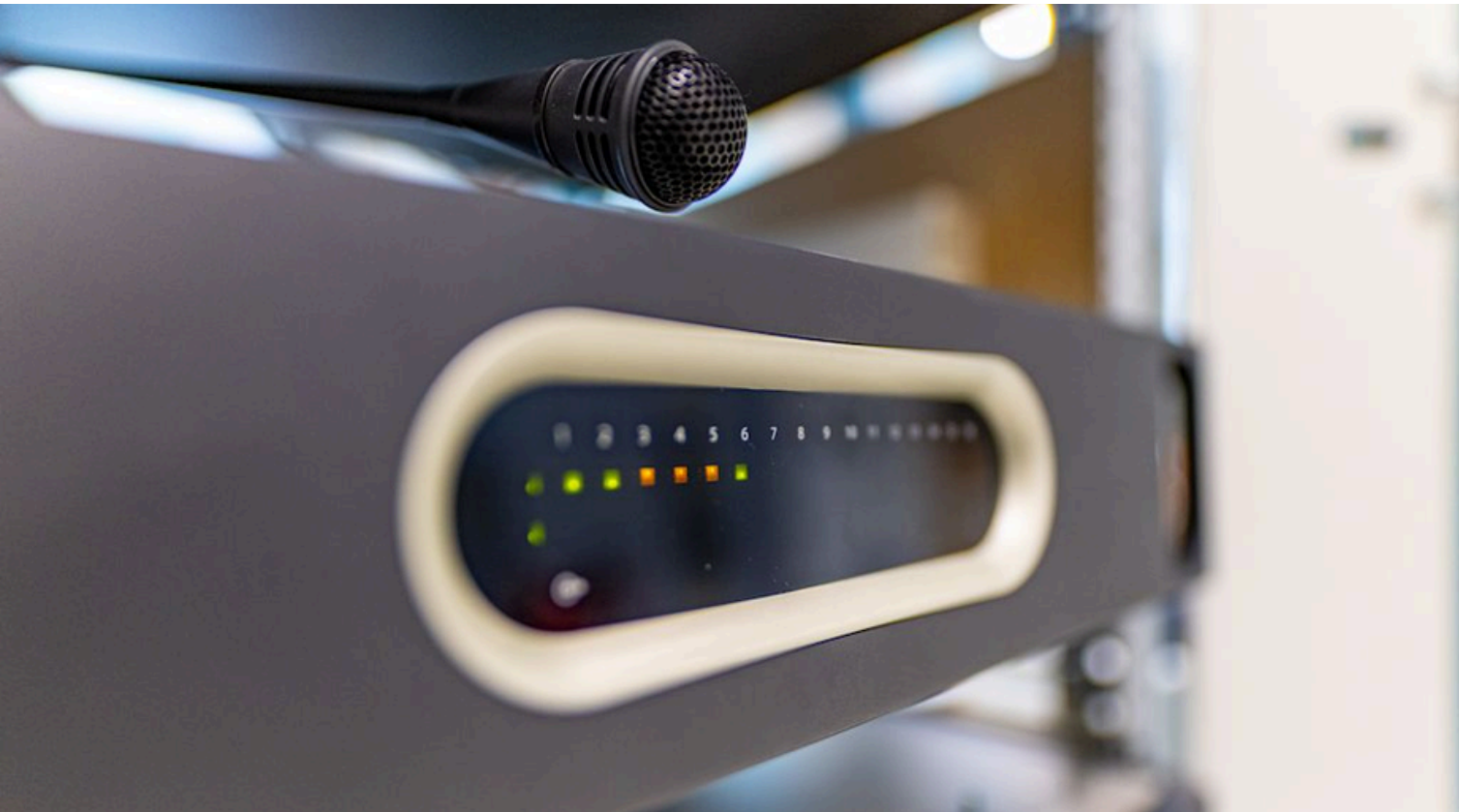
Mehrkanal Schnittstelle zur gezielten Alarmierung unterschiedlicher Bereiche
